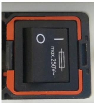
Figura 14: Interruptor de alimentação no painel traseiro
