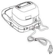
4. Ligar o cabo de alimentação de CA ao conector de alimentação (entrada) da parte posterior do aquecedor, e ligá-lo à tomada de alimentação principal.
