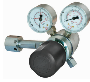
REGULADOR DE PRESSÃO De duplo estágio em aço inoxidável com 2 Manômetros: 0-315 kgf/cm2 e 0-10 kgf/cm2
