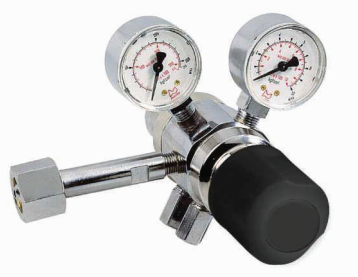
REGULADOR DE PRESSÃO De duplo estágio em latão cromado com 2 Manômetros: 0-315 kgf/cm2 e 0-10kgf/cm2
