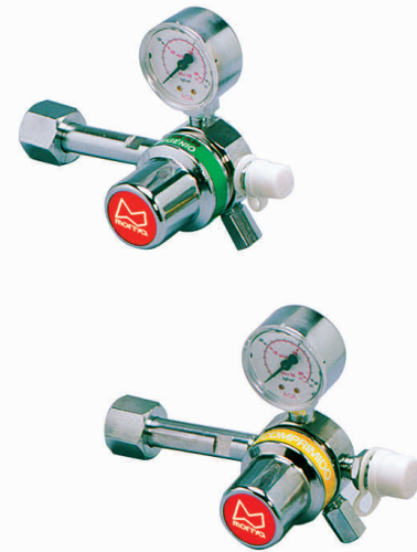
REGULADORES DE PRESSÃO FIXA De 3,5 kgf/cm 2 , em latão cromado, com manômetros de 0-300 kgf/cm 2 . Para cilindro de oxigênio e ar comprimido
